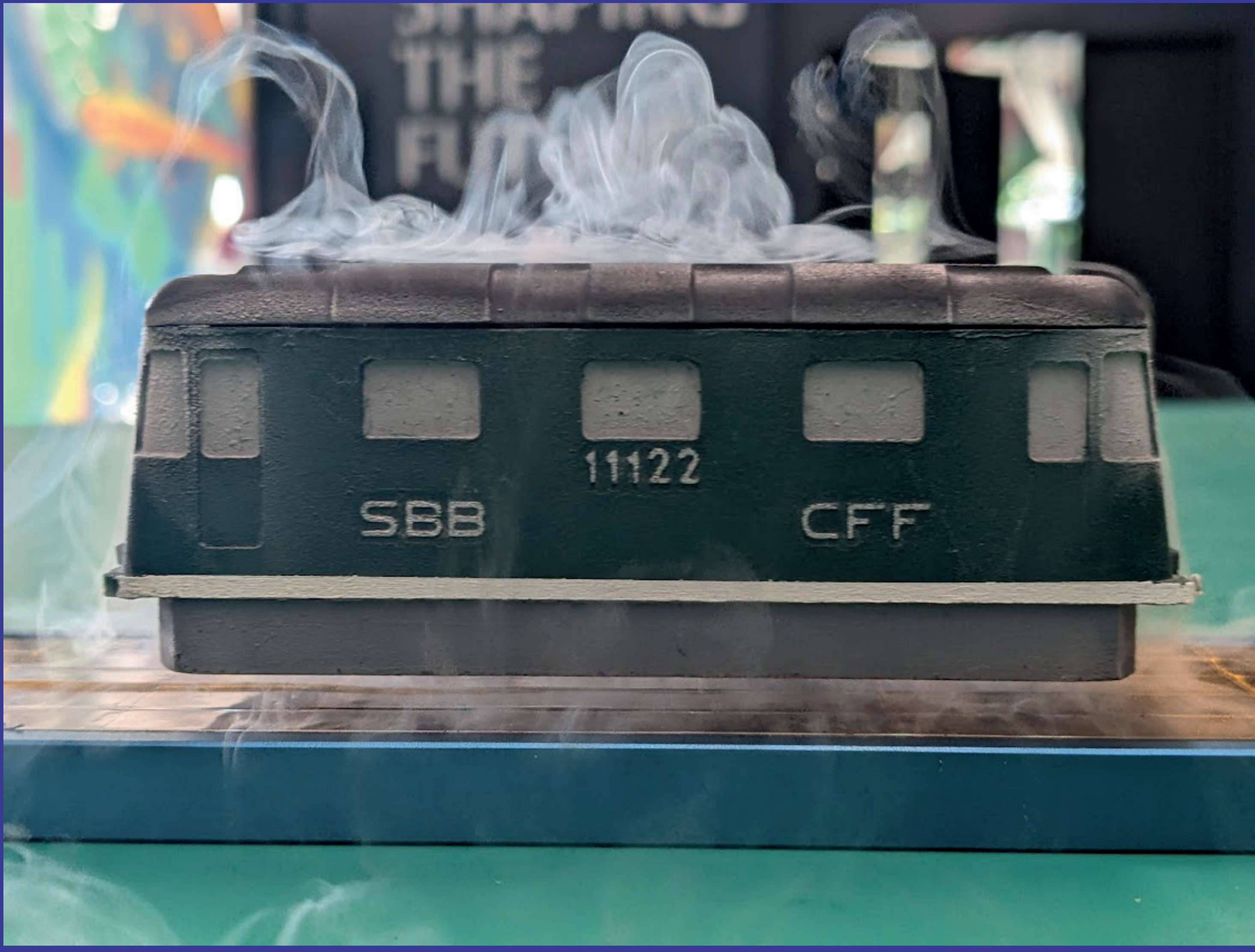
Eine Eisenbahn mit Supraleitern schwebt über Dauermagneten A train with superconductors floats above permanent magnets (Physik-Institut UZH)
